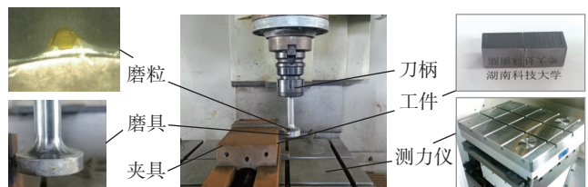
图 2 单颗磨粒磨削加工试验装置图
